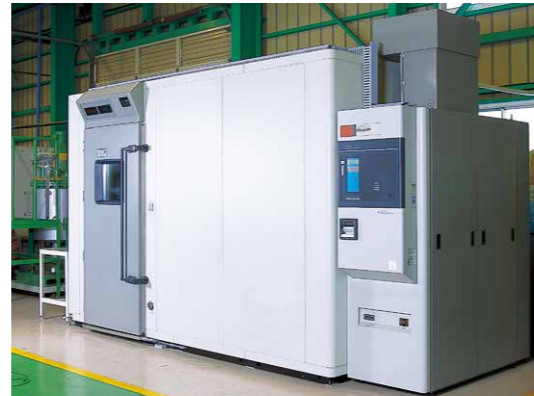
[大型恒温恒湿室] (温度:-30~80℃、湿度:15~95%)
